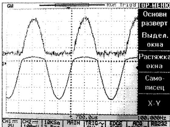
Рис. 5. Осциллограмма анодного тока и напряжения диода
