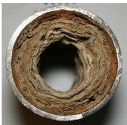
Рис. 1. Загрязнение змеевика при ненадлежащем качестве питательной воды
